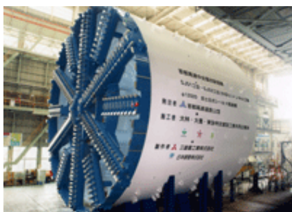
首都高速中央環状新宿線 (外回り)トンネル工事 シールド径：φ12.02m (シールド工法技術協会 HP より)
